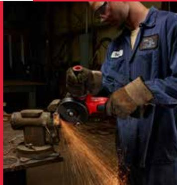
Ideal zum Trennen von Edelstahl, säurebeständigem Stahl, Hardox, Gusseisen, Federband-, Weich- und Werkzeugstahl.
